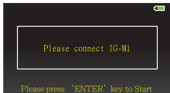
Forbind IG-M1 for at måle Ignition Secondary (sekundær tænding).
