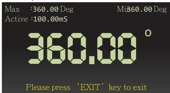
Gå til Ignition Dwell (tændspolens ladetid) og forbind den positive probe (rød) til sensoren og den negative probe (sort) til chassis stel på køretøjet for at udføre målingen.
