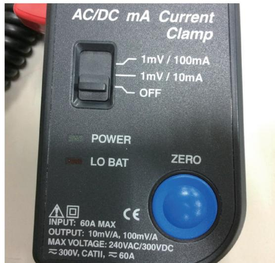
Vælg den korrekte tilstand for Current clamp measuring (strømklemme måling), f.eks. skal kontakten flyttes til 1mV/10mA på Current clamp (strømklemmen) for at måle 1mV=0.01A med CA15.
