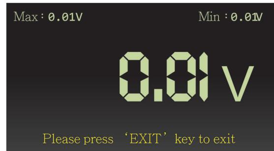
Gå til O2 Sensor (lambdasonde) og forbind den positive probe (rød) til sensoren og den negative probe (sort) til chassis stel på køretøjet for at måle O2 Sensor (lambdasonde) spændingen.
