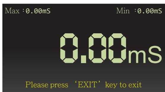
Gå til Active Time og forbind den positive probe (rød) til sensoren og den negative probe (sort) til chassis stel på køretøjet for at udføre målingen.
