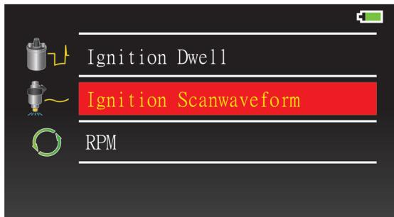
Bekræft Ignition Type (tændingstype) og antal cylindre, når du går til måling af Ignition Dwell Angle (tændspolens ladetid/kamvinkel)
