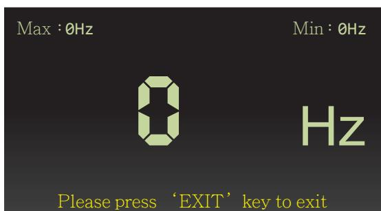
Indtast frekvensen (Hz) og forbind den positive probe (rød) til sensoren og den negative probe (sort) til chassis stel på køretøjet for at måle frekvensen.
