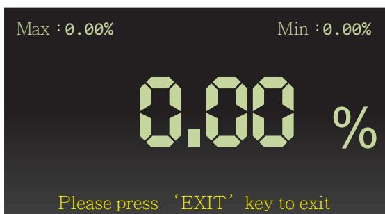
Gå til Duty/Cycle (%) og forbind den positive probe (rød) til sensoren og den negative probe (sort) til chassis stel på køretøjet for at måle procenten.
